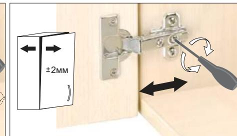
Ослабить крепежный винт и отрегулировать расстояние между дверью и боковой шкафом. Затем снова затянуть крепежный винт.
