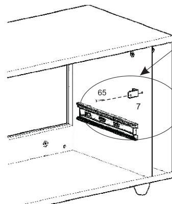
**!** 2 Уголок крепить к стене, через ДВП(задняя стенка) на саморез 4x40мм! Предварительно установив дюбель!
